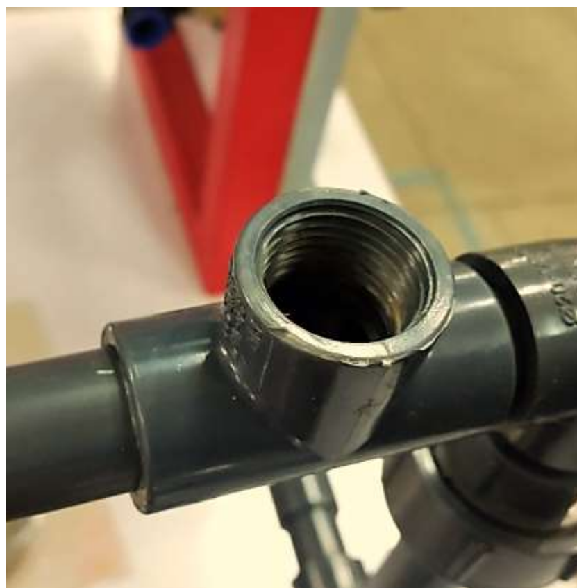
شکل (1): محل اتصال فشار سنج با قطر \frac{1}{2} اینچ
