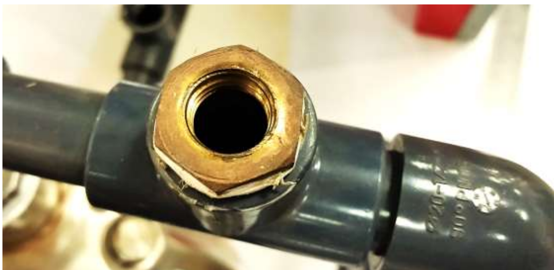
شکل (2): محل اتصال فشار سنج با قطر \frac{1}{4} اینچ (در صورت نیاز تیم شرکت کننده)
